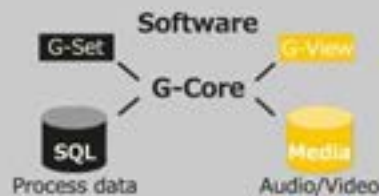
Arquitectura dual de base de datos Accesibilidad instantánea a imágenes y metadatos
